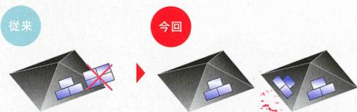
従来のシステム構成には標準回路(太陽電池モジュール7枚<sup>※7</sup>以上の直列回路)が必要のため、小さな屋根には設置できませんでした。
